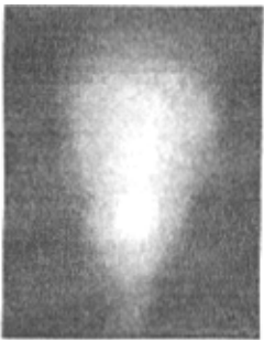
图 13 压弯五万步后距光源点 30.50 m 处光斑
